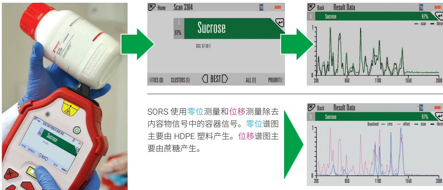
图 4. SORS 将零位测量和位移测量相结合来获得容器内容物的高质量谱图
